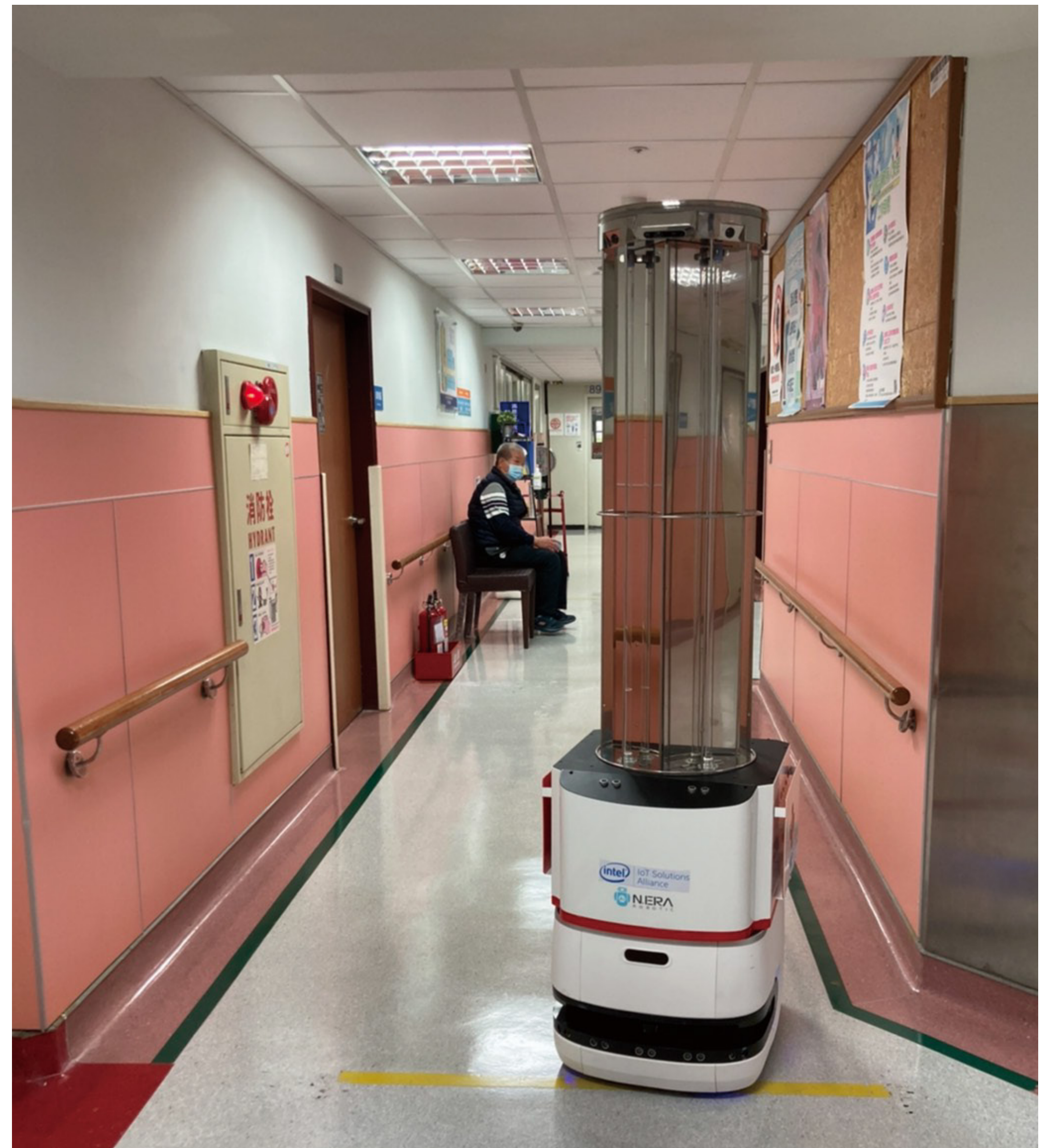
타이중 보훈 종합병원의 복도 폭은 80~85cm로 실제로 상당히 좁다. 앞에 의료진이나 장비가 있으면 충돌이 불가피한 구조이다. 따라서 설계 프로세스 초기에 위험 식별 또는 위험 평가 방법은 충돌 가능성을 최소화하도록 섬세하게 처리되어야 한다.
